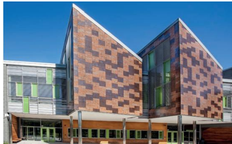
Ilustración 22 Fachada ventilada en gres porcelánico (46)
