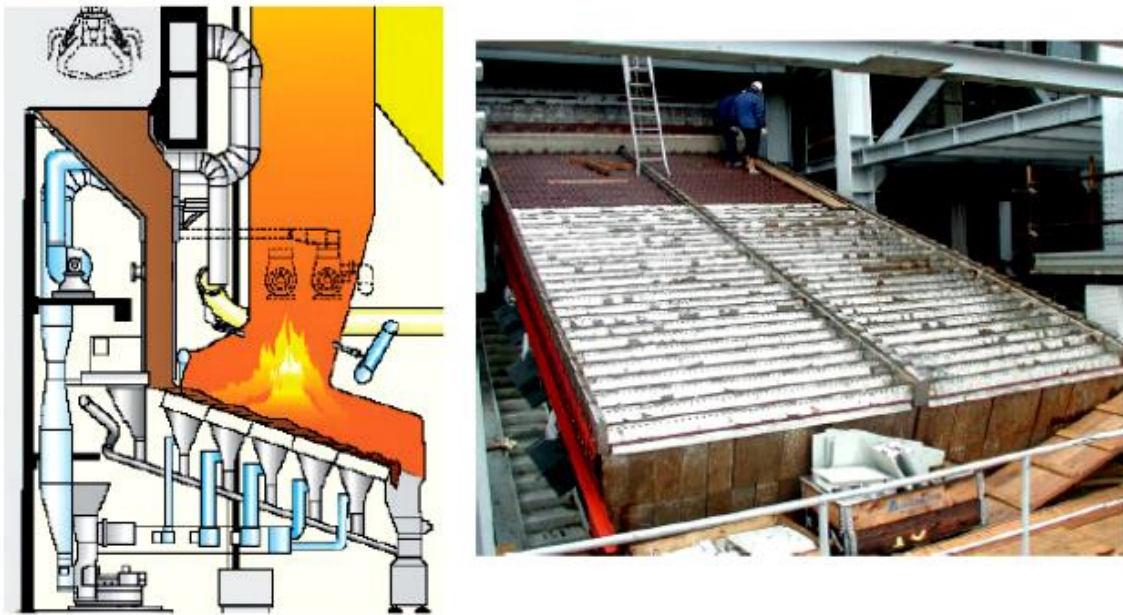
Ilustración 48. horno de parrillas. (seleccionado para nuestro proyecto)
