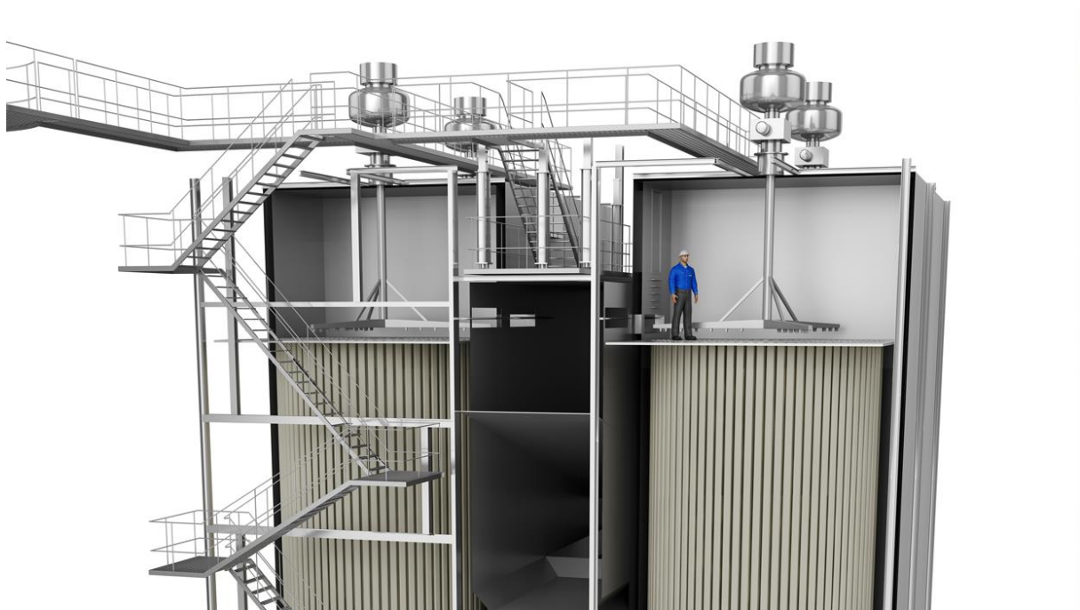
Ilustración 37. Interior de un filtro de mangas
