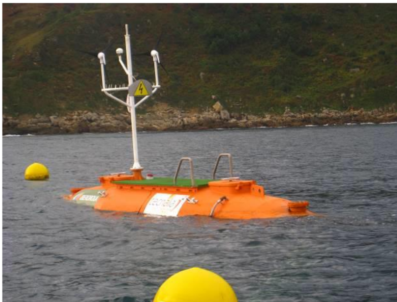
Figura 23: Modelo a escala 1:4 en las pruebas de mar del prototipo de TECNALIA (23)
