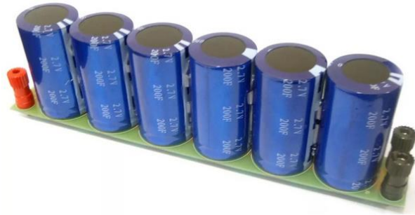
Figura 30: Banco de supercapacitores (90)
