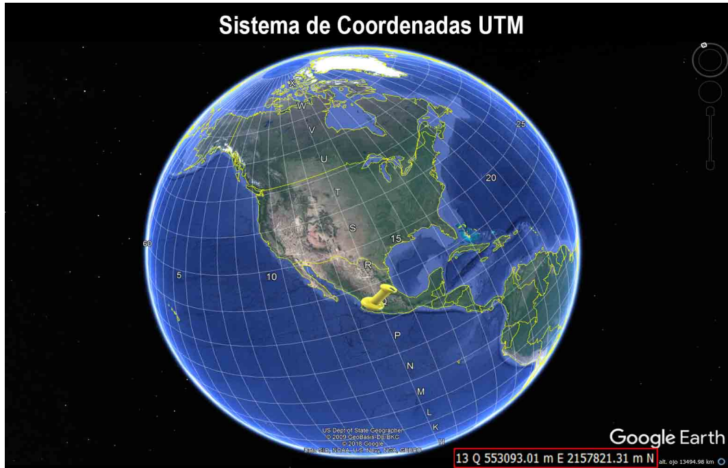
Figura 4.4: Cuadrícula de zonas UTM que le corresponden a México (zonas 11 a 16 Norte). En el globo obtenido de la aplicación Google Earth, podemos observar la zona marcada con una chincheta amarilla que corresponde a Jalisco, esta área está gestionada sobre las coordenadas UTM zona 13 Norte datum WGS84, que son parte de las zonas con denominación de origen del agave. Derechos de autor Google Earth 2019 TM , [63].
