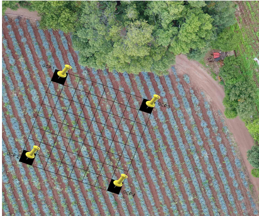
Figura 4.8: Los puntos de control en tierra o Ground Control Points (GCP), son objetivos marcados en el suelo, espaciados estratégicamente a lo largo de su área de interés.
