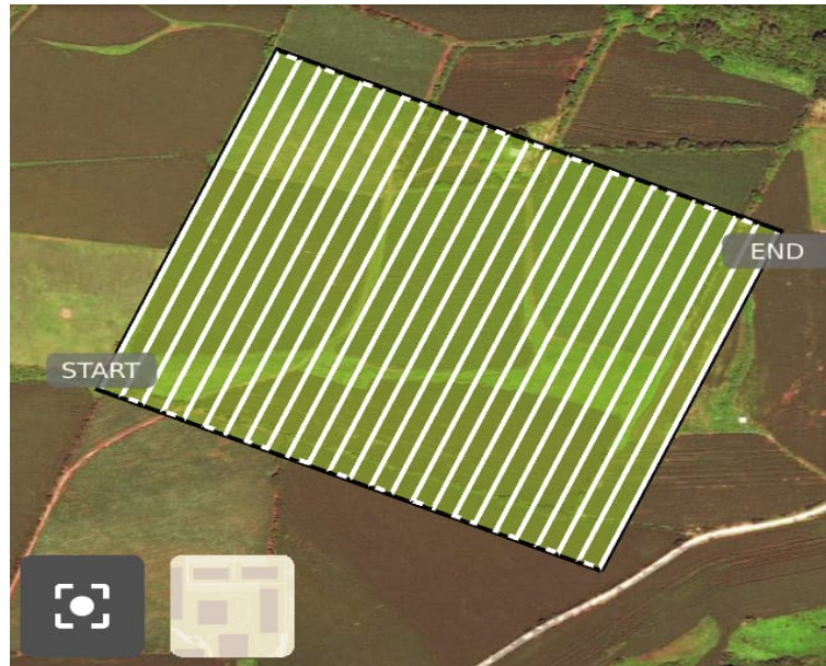
Figura 4.7: Ejemplo de Plan de Vuelo generado por la aplicación Pix4D Capture.
