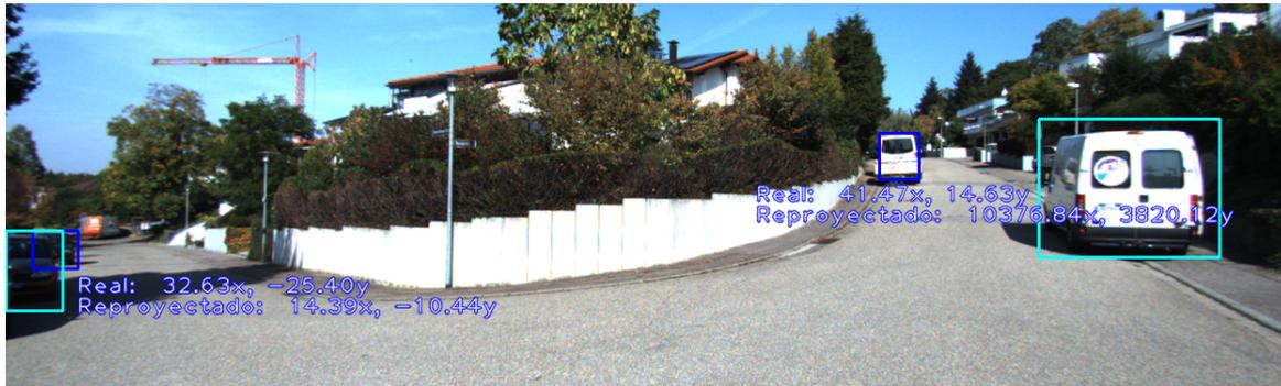
**Figura 4.10:** Imagen de validación del *dataset* KITTI, en el que comprobamos el error cometido en la reproyección frente a los valores reales de posición en un *bounding box* cercano a la línea del horizonte.
