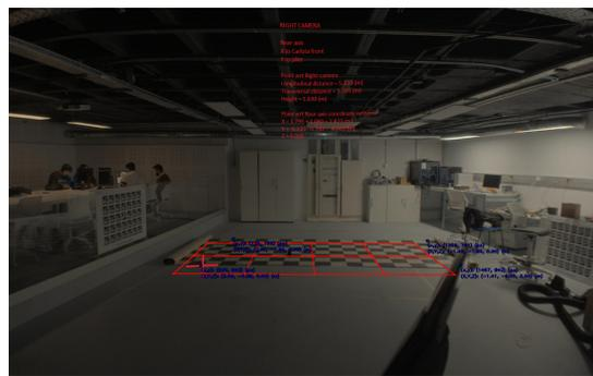
(b) Calibración para la cámara derecha.
