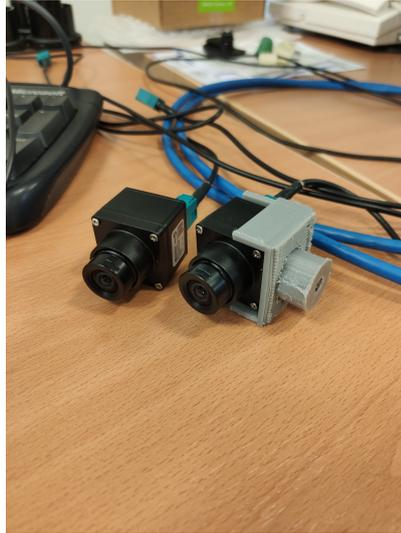
**Figura 3.3:** Dos de las cámaras Sekonix instaladas en el coche.
