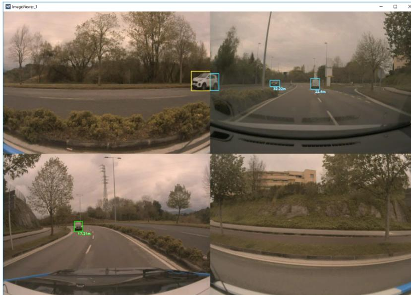
**Figura 3.11:** Detección de objetos a tiempo real en RTMaps usando YOLO v3 en CarLOTA.
