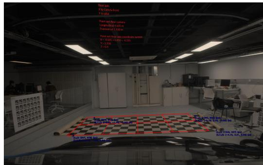
(d) Calibración para la cámara trasera.
