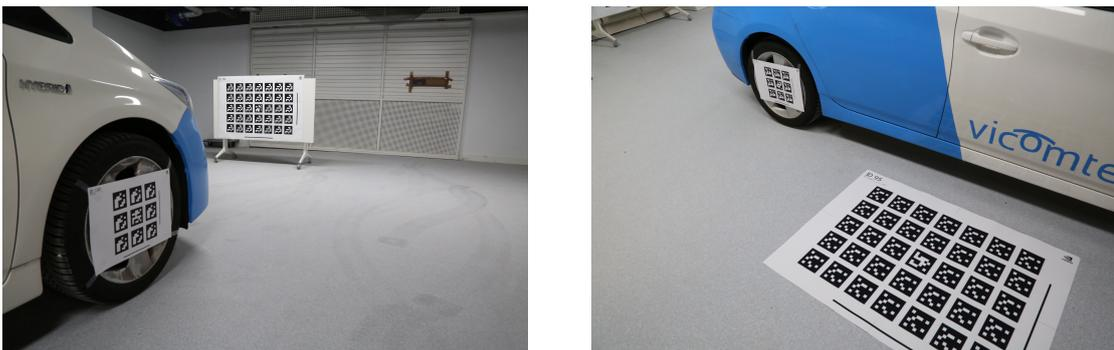
**Figura 3.5:** Dos fotos de ejemplo en el que se muestran dos marcadores para la calibración de extrínsecos de las cámaras.
