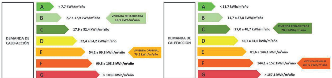
Figura 5. Calificación energética de los edificios antes y después de ser rehabilitados en la zona climática C (izq) y zona climática D (dcha).
