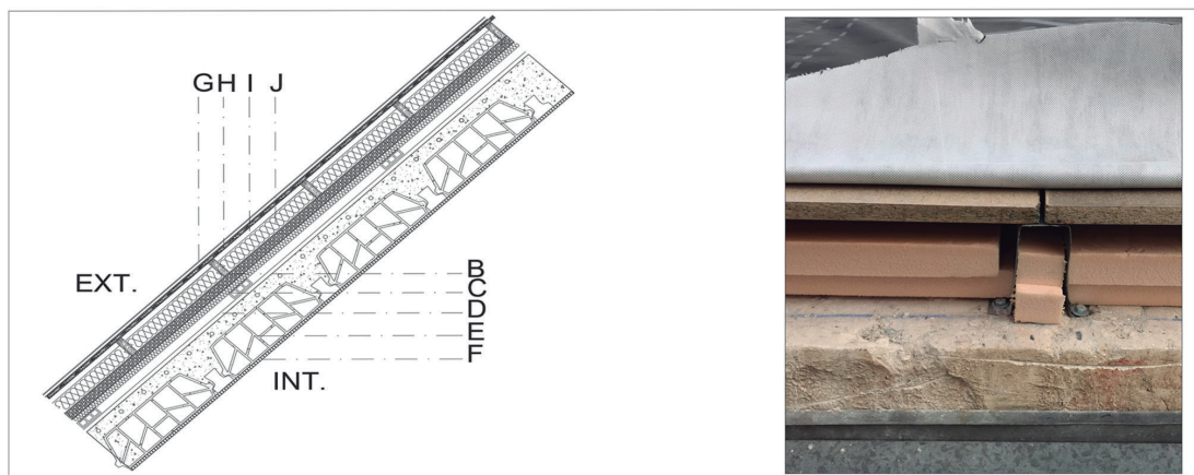
Figura 7. Sección constructiva de la cubierta propuesta. Imagen de la cubierta de zinc después de la rehabilitación.
