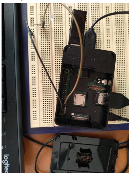
E4 Irudia: Raspberry Pi-a periferikoetara konektatu eta LED zirkuitua muntatu .
