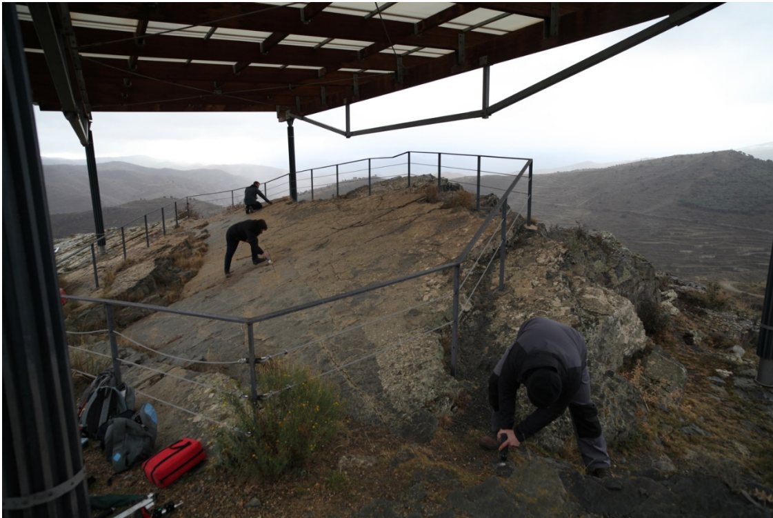
Fig. 3.- Implantación de clavos de acero de la red de referencia.
