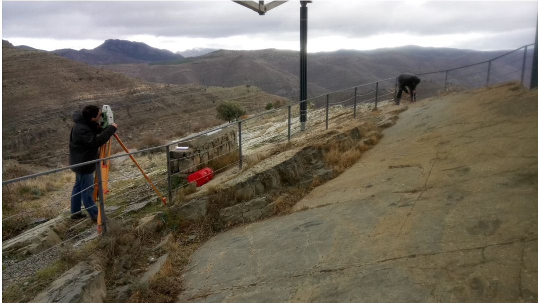
Fig. 4.- Medida de puntos de apoyo con estación total (fotografía de Angélica Torices).
