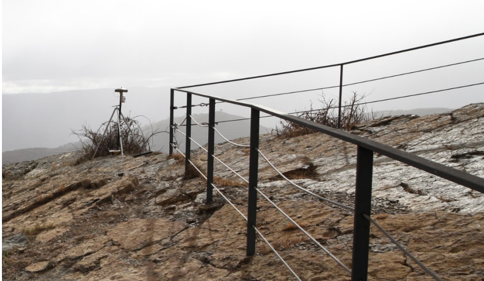
Fig. 5.- Situación del receptor GNSS sobre uno de los clavos de referencia
