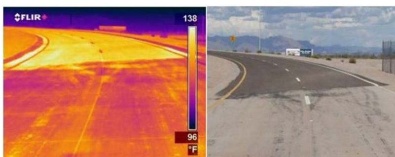
Ilustración 4.10 - Diferencias de temperatura (Fº) entre dos pavimentos. (Fuente: Heat Island Group)
