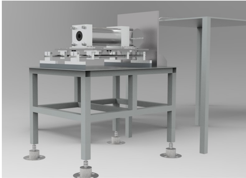
Figura 7.6: Vista en perspectiva de la cámara de combustión sobre la mesa soporte.
