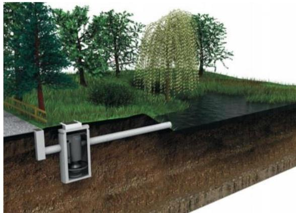
Ilustración 5-12. Pozo de infiltración.
