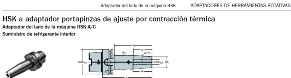
Ilustración 52: Adaptador para brocas y fresas enterizas
