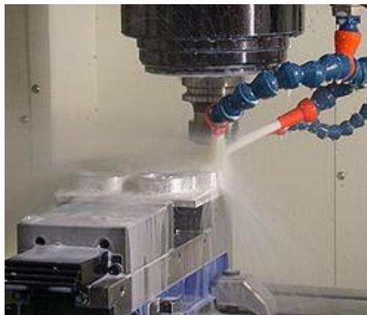
Ilustración 36: Refrigeración de una operación de mecanizado
