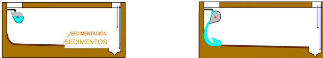
Figura 19: Esquema de limpiadores basculantes en reposo y en acción
