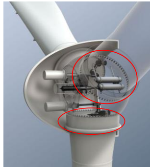
Figura 10. Rodamientos convencionales en las palas y en el sistema de orientación de los aerogeneradores [14].
