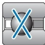
Figura 3. Pista de rodadura con configuración de cuatro puntos de contacto [7].
