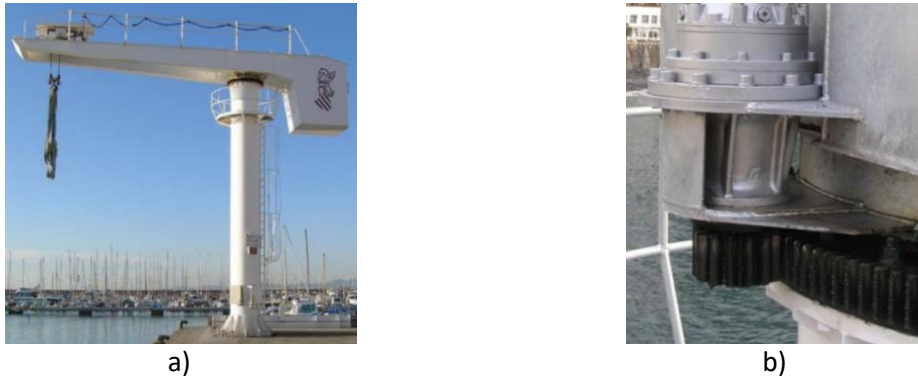
Figura 11. a) Grúa portuaria b) Rodamiento convencional [15].
