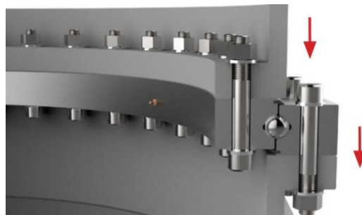
Figura 6. Montaje a compresión de los rodamientos convencionales [5].
