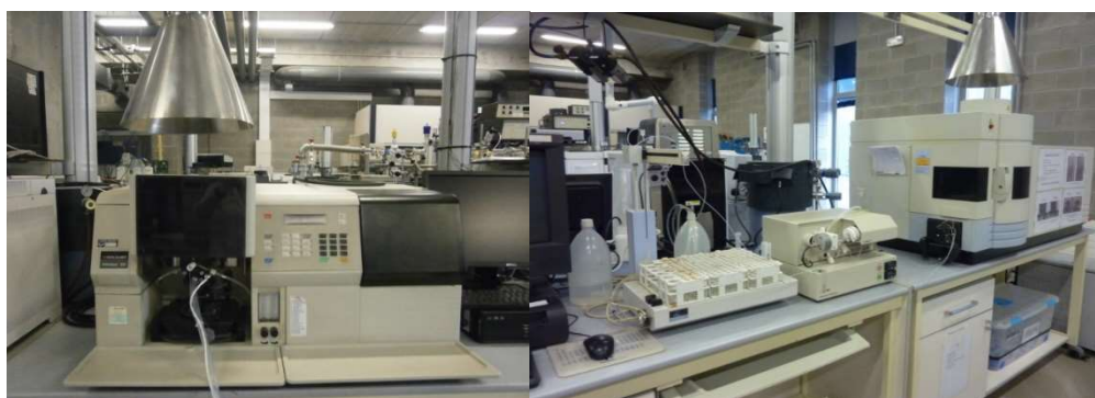
16. irudia. AAS (Perkin Elmer AAnalyst 100 ) eta IPC-OES (Perkin Elmer Optima 2000 DV) ekipoak. I. eranskinean ekipamendu hauek maneiatzeko gida aurki daiteke.
