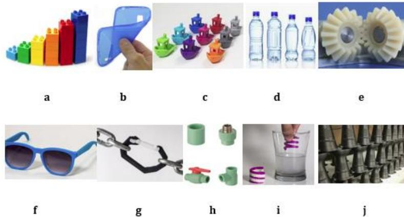
*Figura 20: Empezando desde la “a” piezas fabricadas en: A.B.S. PLUS, T.P.U., P.L.A., P.E.T., Nylon, A.S.A., P.C., Polipropileno, P.V.A. y Onyx. [22]*
