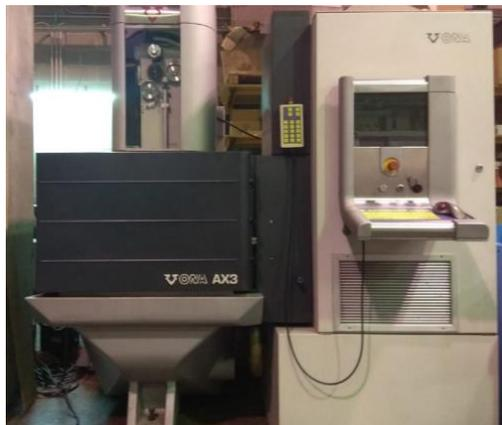
*Figura 32: Máquina W.E.D.M. ONA AX-3.*
