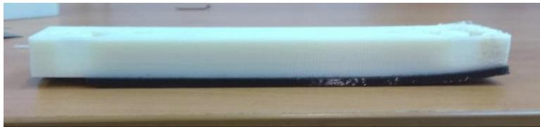
*Figura 22: Pieza de ABS PLUS afectada por el warping.*
