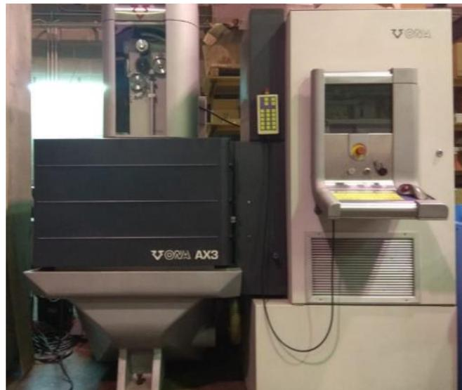
Figura 3: Máquina de corte por hilo ONA-AX3.
