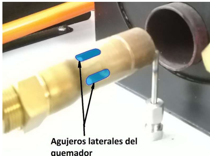
Figura 2. Agujeros del quemador
