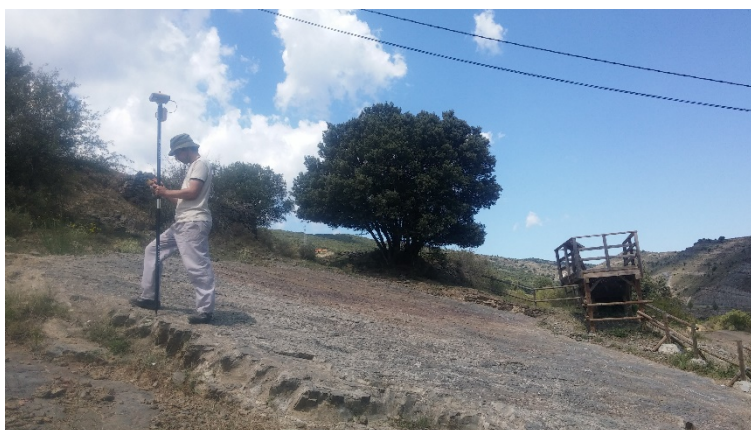
Fig. 5. Proceso de observación mediante técnicas GNSS-RTK de la delimitación general del yacimiento.
