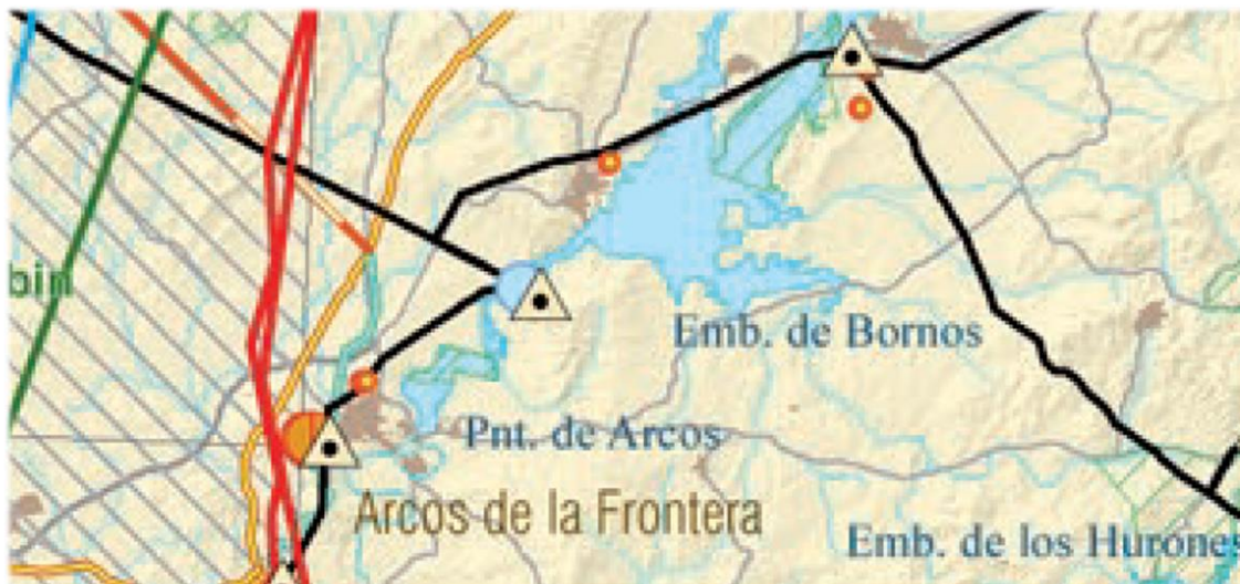
Figura 72: Detalle de la red de transporte eléctrico del entorno del pantano. Línea negra red a 66 kV, línea roja red a 400 kV. Fuente: Junta de Andalucía
