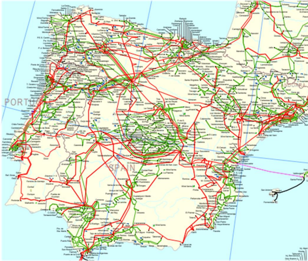
Figura 34: Principales líneas de transporte y distribución de España. Fuente: Red Europea de Gestores de Redes de Transporte de Electricidad (ENTSOE)
