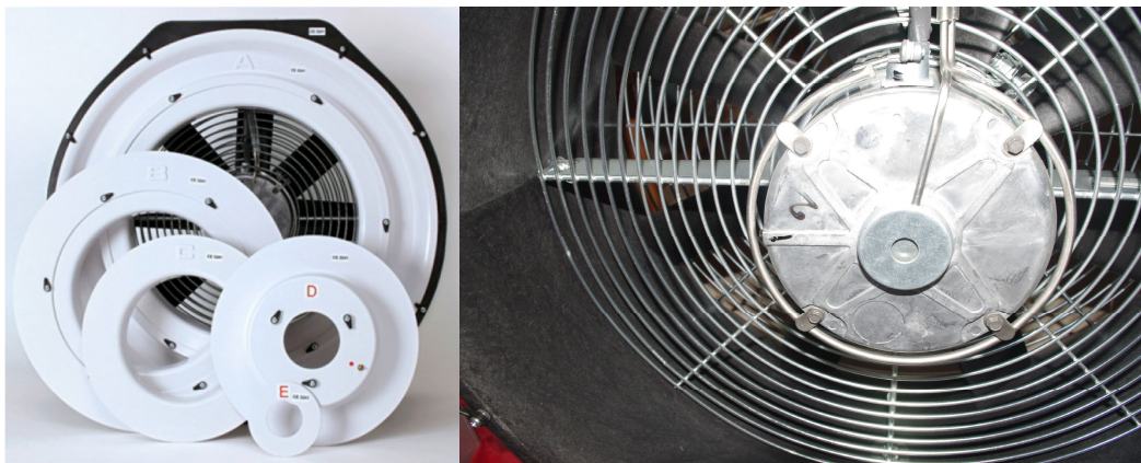
2. 9. Irudia- Minneapolis Model 4 haizagailuaren uztaiak (A-E) eta presio sentsorea aire-emaria kalkulatzeko.
