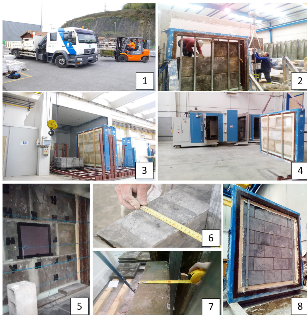
2. 25. Irudia- Gordetako kutxa beroan burutu den prozedura hormen saiakuntzak garatzeko (1- Materialen garraioa Donostiako biltegitik Gasteizko Laborategira, 2- Hormen eraikitzea, 3- Hormen lehortzea, 4- Saiakuntzarako ekipamenduaren irekitzea, 5- Zundak instalakuntza, 6/7- Hormen lodiera, 8- Kareharrizko horma).
