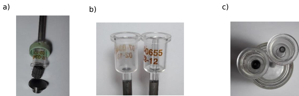
Figura 2.7. a) porta muestras con su precinto, b) y c) penetrómetro para sustrato estructurado (izquierda) y penetrómetro para muestras en polvo (derecha).
