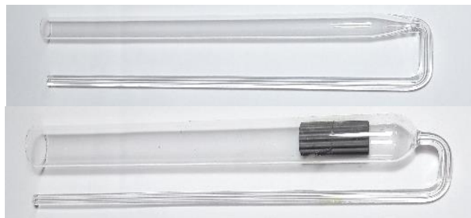
Figura 2.8. Imagen del porta muestras de sólido (arriba) y porta muestras de los sustratos estructurados (abajo).
