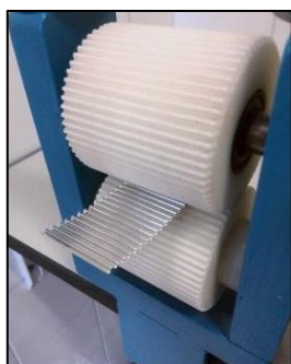
Figura 2.3. Imagen del rodillo corrugador utilizado.
