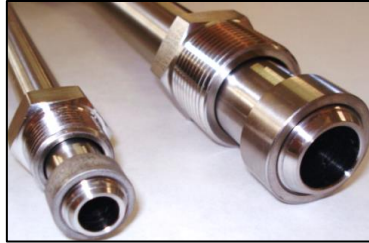
Figura 2.17. Imagen de los reactores tubulares de 9 mm y 17 mm.
