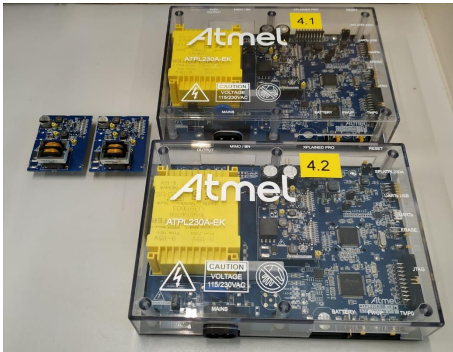
Figura 7: Placas base ATPL230AMB y placas de acoplamiento ATPLCOUP001 v1 (fuera) y ATPLCOUP006 v2 (en la placa base).
