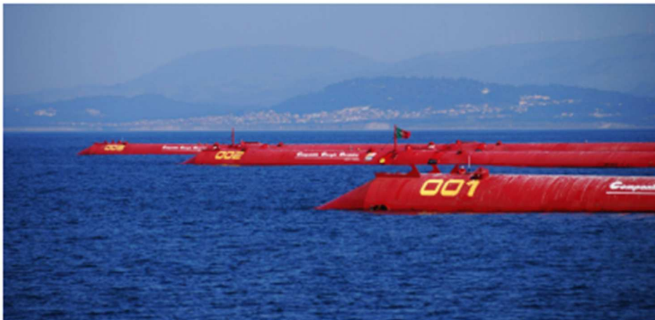
Figura 16. Instalación de dispositivos Pelamis en Portugal [15]
