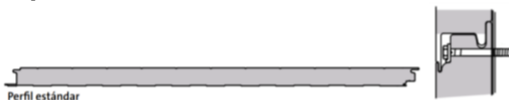
2.26.Irudia: Hormetako panelen profila eta lotura
