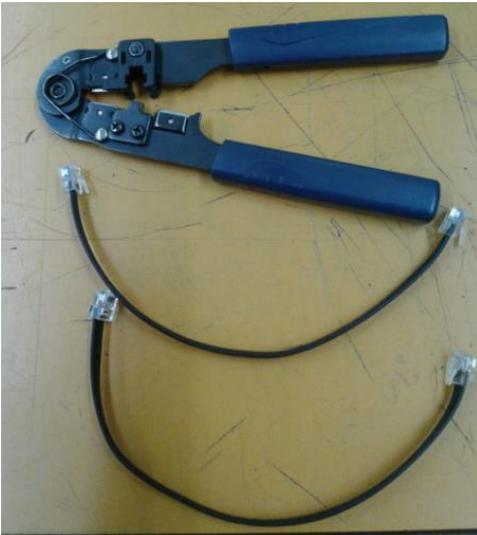
**Ilustración 44: Cables RJ12 crimpados y crimpadora**
