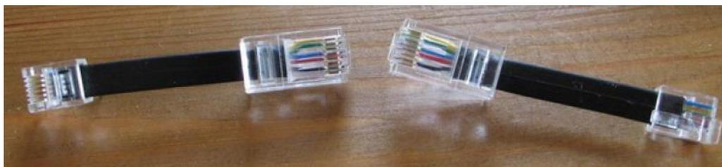
**Ilustración 41: Medios cables RJ12 Lego**
