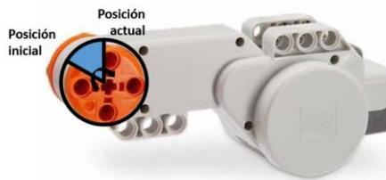
**Ilustración 35: Variación de ángulo del motor**
