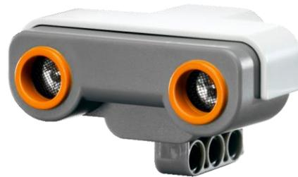
**Ilustración 8: Sensor ultrasónico**
