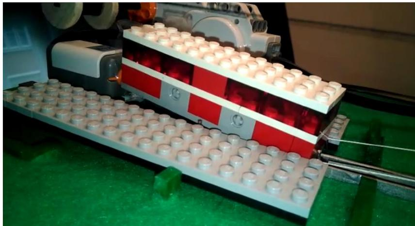
Ilustración 15: Unión del hilo al vagón por debajo
