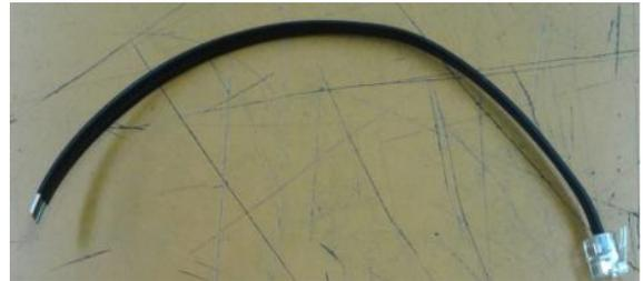
**Ilustración 43: Cable RJ12 cortado**
