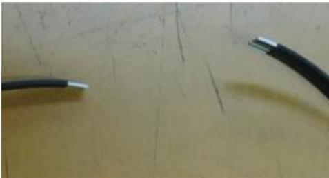
**Ilustración 42: Corte del cable RJ12**
