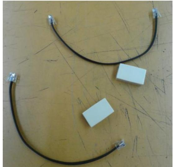
**Ilustración 45: Cables crimpados junto con los acopladores**
