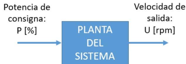
Ilustración 32: Esquema control bucle abierto
