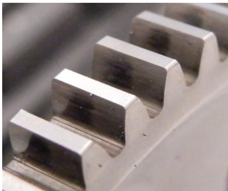
Ilustración 2.11: Quemado de pieza en dientes de un engranaje. Fuente: Escuela Técnica Superior de Ingeniería
