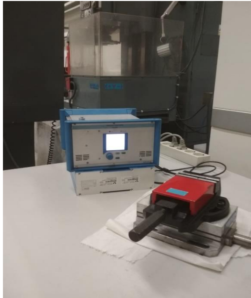
Ilustración 3.4: Kistler junto a la mesa dinamométrica y mordaza
