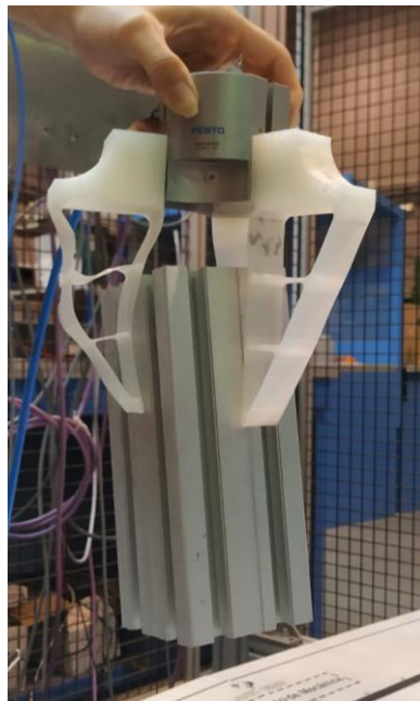
Figura 40: Prueba de agarre geometría tipo perfil.
