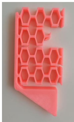
Figura 19: Fabricación en PLA del mecanismo biestable.
