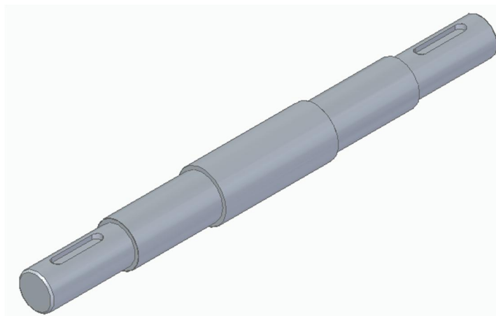
Ilustración 16 La forma de la pieza después del chaflán atada 2
