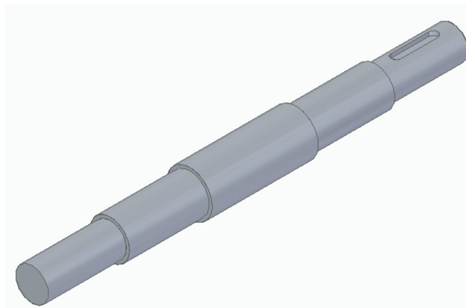
Ilustración 12 La forma de la pieza después del cilindrado 2 atada 2
