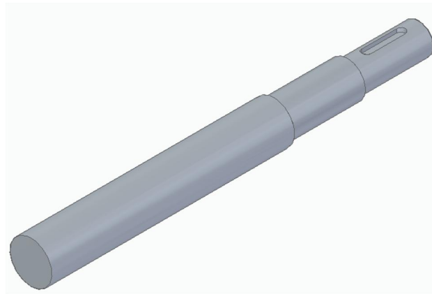
Ilustración 10 La forma de la pieza después del refrentado atada 2
