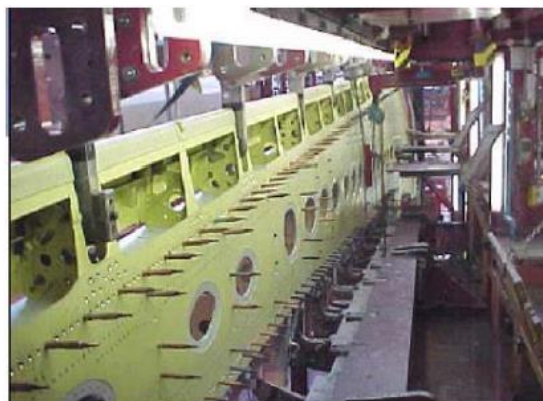
Figura 2: Utillaje Especifico para el ensamblaje del ala (Airbus UK).
