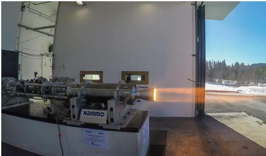
Ilustración 6. Una estructura soporte con la cámara de combustión encendida.
