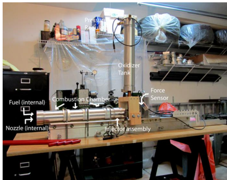
Ilustración 18. Perfil del test stand de Spiegl.
