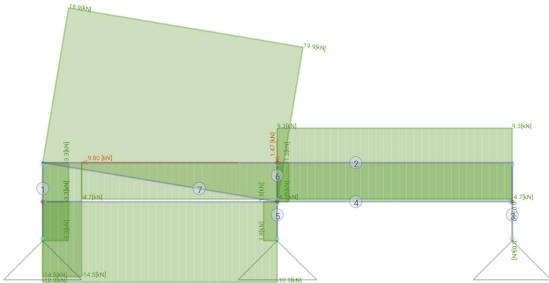
Ilustración 36. Diagrama de esfuerzos normales con Frame Design .
