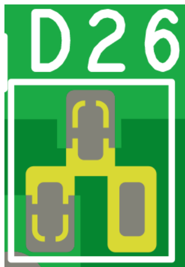
Captura 38. Captura de la previsualización de los pads del componente D26.
