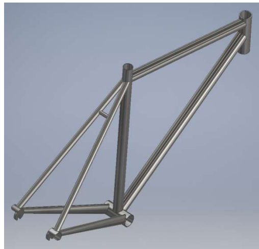
Figura 4. Modelo no simétrico del cuadro
