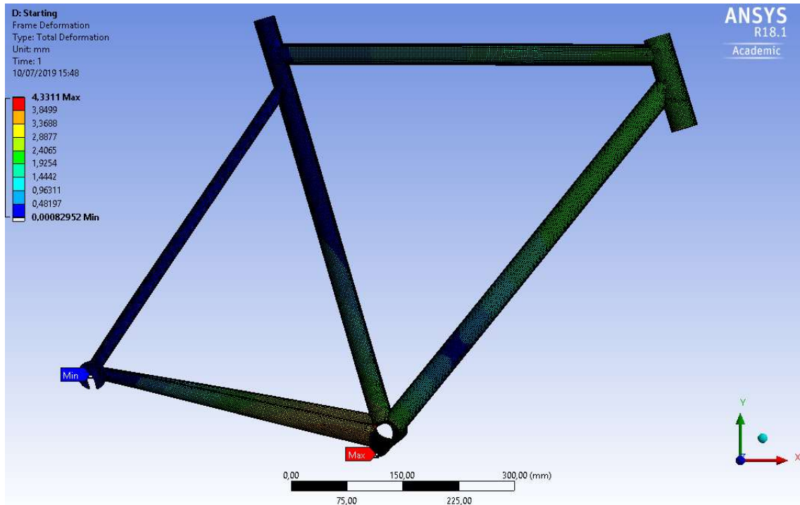
Figura 26. Deformación total. Empezando a pedalear.
