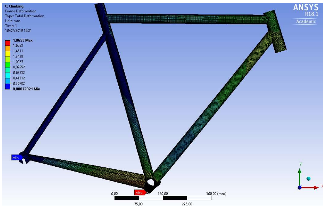
Figura 30. Deformación total. Subiendo una cuesta.
