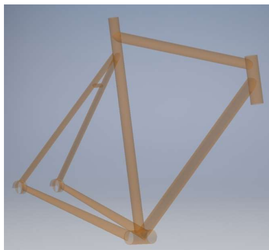
Figura 17. Cuadro de la bicicleta por superficies (para cálculos con cargas no simétricas).
