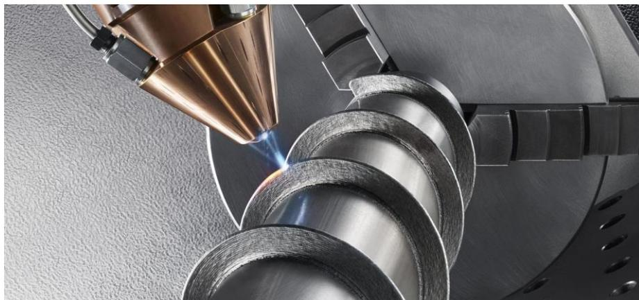
*Ilustración 1. Laser Metal Deposition (LMD)*
