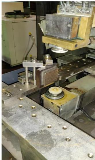
Ilustración 13. Máquina de corte por electroerosión
