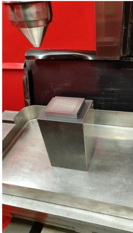
*Ilustración 9. Precalentamiento sustrato AISI 1045*
