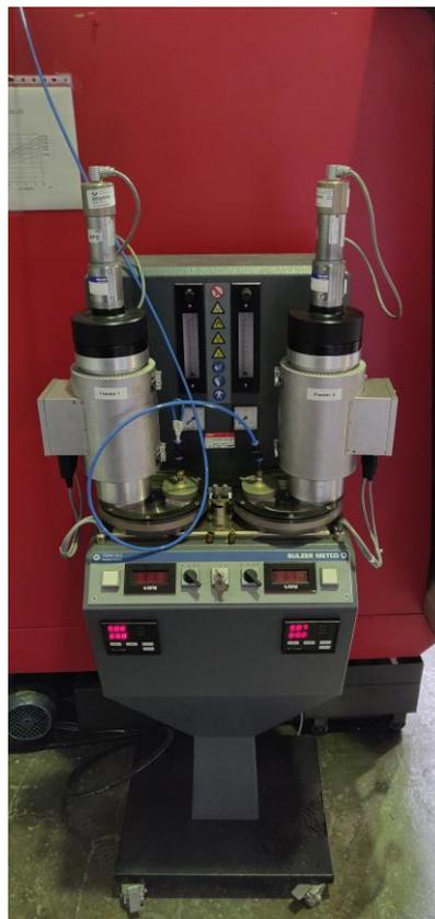
Ilustración 2. Alimentador de polvo “Sulzer Metco Twin 10-C Powder Feeder”
