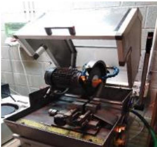
Ilustración 16. Sierra metalográfica
