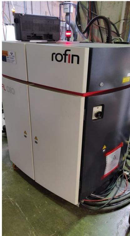
Ilustración 3. Generador laser de fibra "Rofin FL010"
