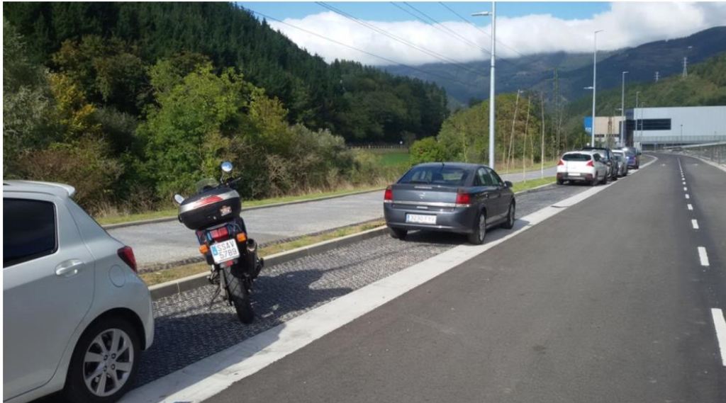
20. irudia: aparkaleku bateko zoladura iragazkorra. Iturria: drenajesostenible.com
