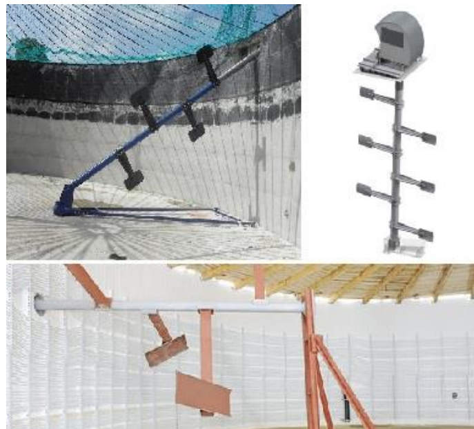
Figura 25. Agitadores de paletas. Inclinado (izq. arriba) [92], vertical (dcha. arriba) [92] y horizontal (abajo) [91].
