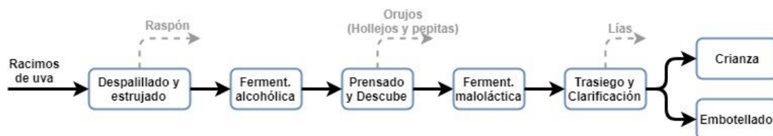
Figura 13. Esquema básico del proceso de vinificación en tinto mediante despalillado y estrujado. Elaboración propia.
