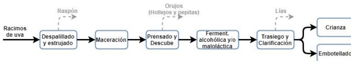
Figura 15. Esquema básico del proceso de elaboración del vino blanco y rosado. Elaboración propia.
