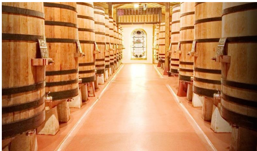
Figura 48. Depósitos de fermentación en Bodegas Muga que se utilizarán después de su retirada para el almacenamiento de lías [149].
