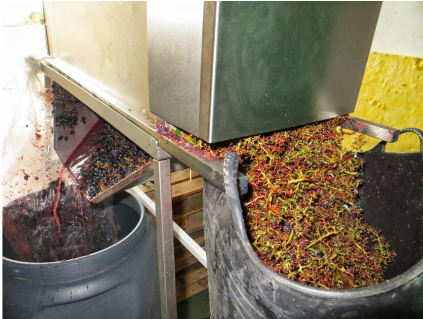
Figura 14. Despalilladora/estrujadora en funcionamiento. A la derecha se recoge el raspón y a la izquierda la uva estrujada [37].
