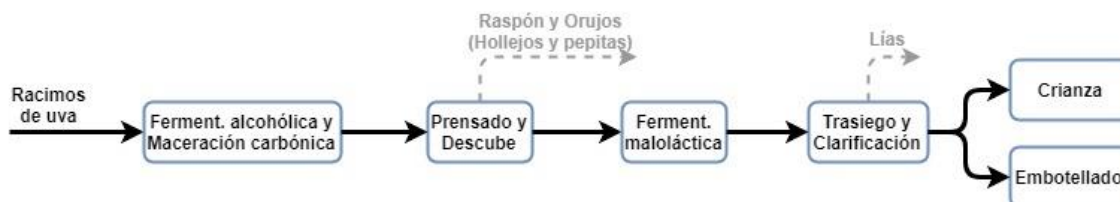
Figura 11. Esquema básico del proceso de vinificación en tinto mediante maceración carbónica. Elaboración propia.
