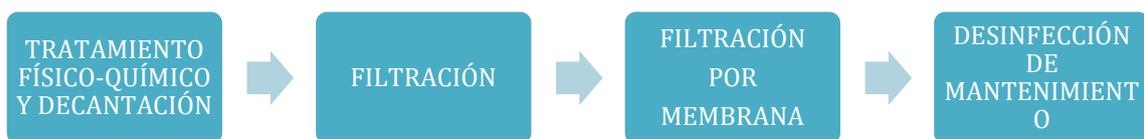
Figura 18: Tratamiento para regeneración de aguas a realizar. [Elaboración Propia]
