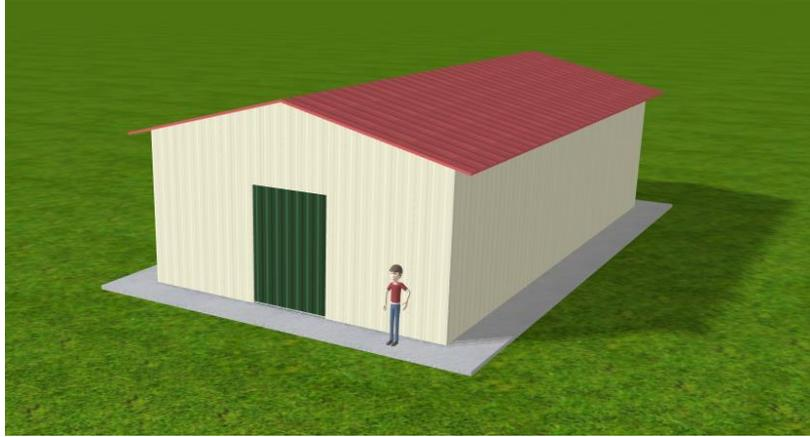
**Figura 46: Diseño 3D de la nave prefabricada para la protección del equipo de ultrafiltración. [46]**
