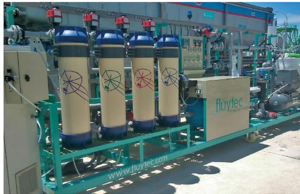
**Figura 45: Equipo de ultrafiltración continua de Fluytec. [45]**
