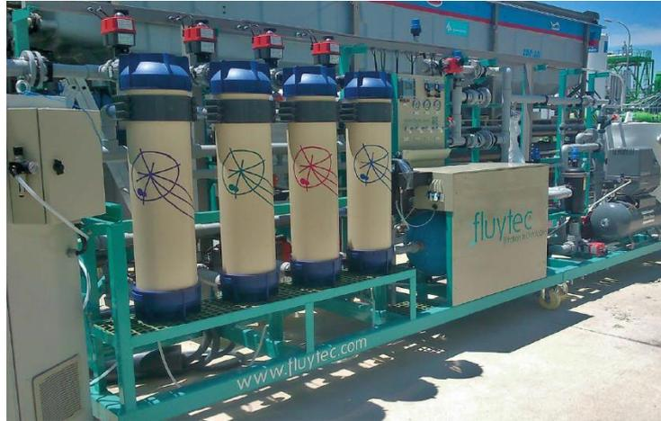
Figura 35: Equipo de ultrafiltración continua de Fluytec. [45]
