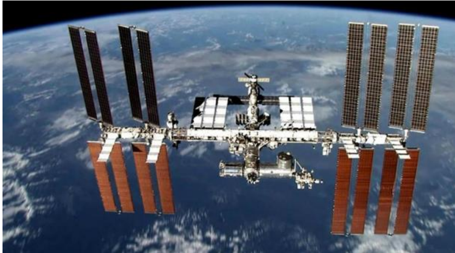
Imagen 14: Estación Espacial Internacional. Paneles fotovoltaicos.
