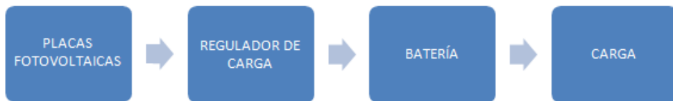
Imagen 12: Esquema de sistema fotovoltaico con regulador v batería
