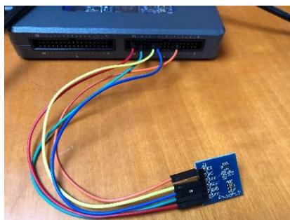
Ilustración 200: Diagrama esquemático, construcción recomendada en la protoboard y conexión al conector MXP B de NI myRIO del sensor de luz ambiental.
