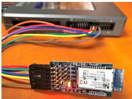
*Ilustración 243: Diagrama esquemático, construcción recomendada en la protoboard y conexión al conector MXP B de NI myRIO del bluetooth.*
