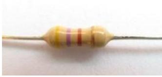
*Ilustración 136: Resistencia 470  $\Omega$*
