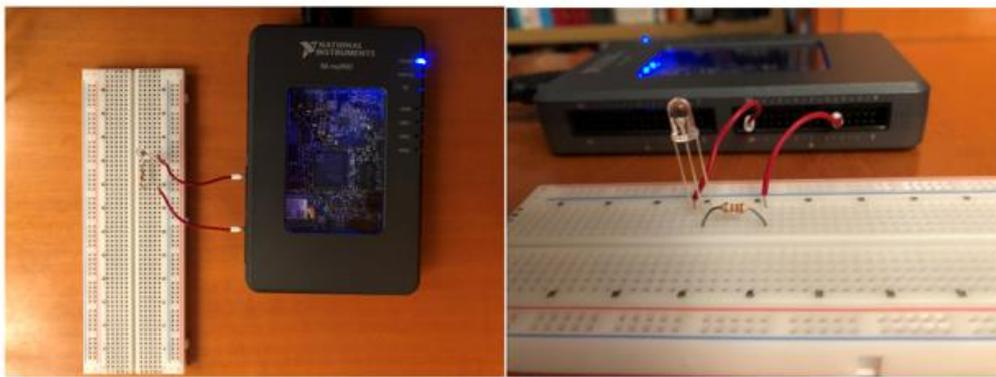
*Ilustración 52: Diagrama esquemático, construcción recomendada en la protoboard y conexión al conector MXP B de NI myRIO del LED de tres terminales.*
