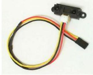
Ilustración 170: Telémetro IR.
