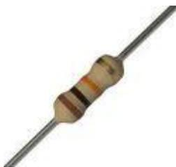
*Ilustración 259: Resistencia 10  $\text{k}\Omega$*
