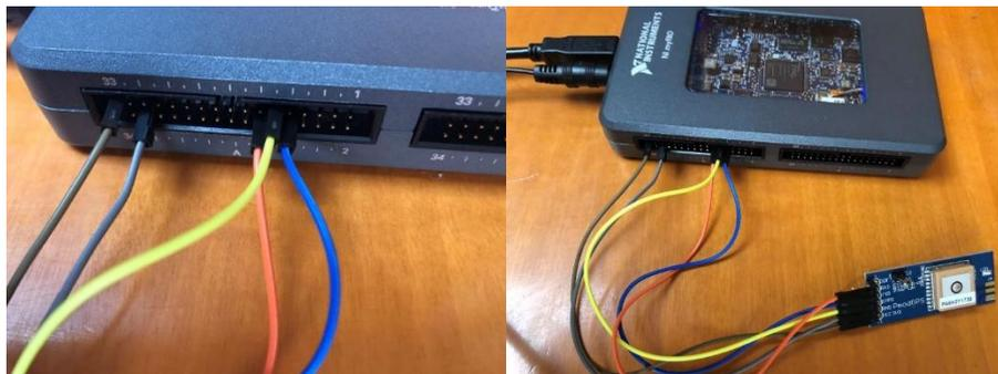
Ilustración 270: Diagrama esquemático, construcción recomendada en la protoboard y conexión al conector MXP A de NI myRIO del GPS.
