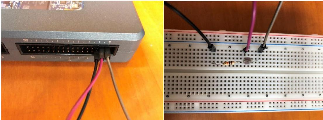
Ilustración 100: Diagrama esquemático, construcción recomendada en la protoboard y conexión al conector MXP B de NI myRIO de la fotorresistencia.
