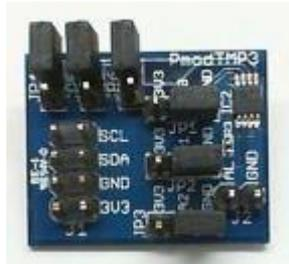
Ilustración 249: Sensor de temperatura.
