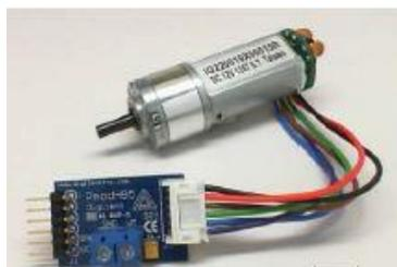
*Ilustración 163: Puente H (PmodHB5) y motorreductor.*
