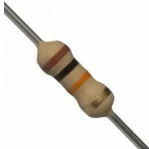
*Ilustración 94: Resistencia 10 k $\Omega$*
