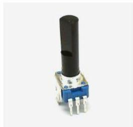
*Ilustración 77: Potenciómetro.*
