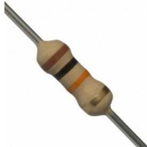
*Ilustración 85: Resistencia 10 k $\Omega$*
