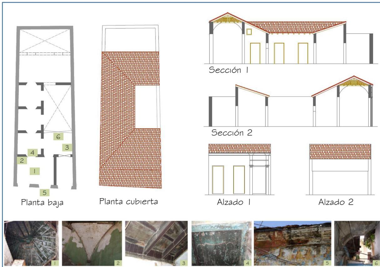
Figura 60. Planos técnicos y fotografías del inmueble situado en la C/San Isidro nº 114 de la manzana 303. Fuente: Elaboración propia.
