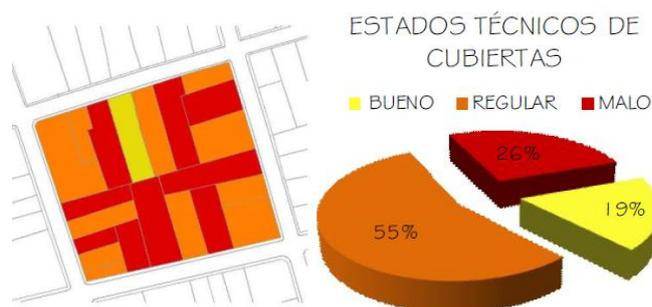
Los datos reflejados en las Figuras 48 y 49 a propósito del estado técnico de las cubiertas son alarmantes puesto que prácticamente la totalidad de la manzana presenta cubiertas con estado técnico malo o regular, precisándose una intervención inmediata que detenga el deterioro general de la manzana.
