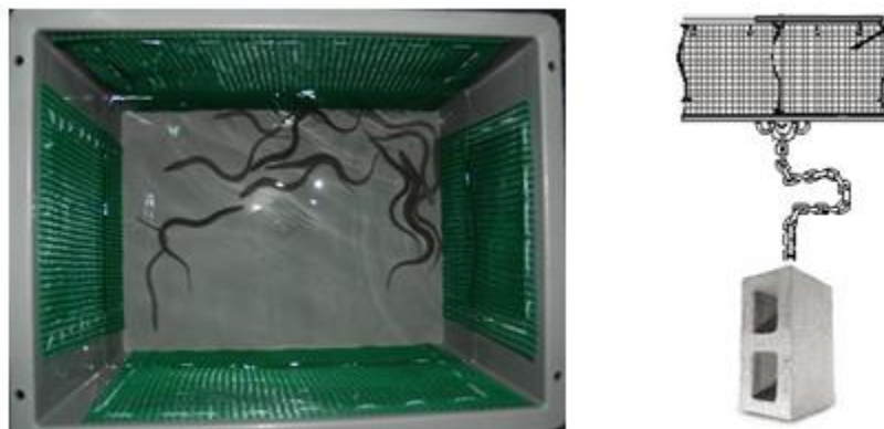
3. Irudia: Laginketa-estazio bakoitzean kokatutako kaiola eta esperimentuan erabilitako aingirak. Kaiolaren dimentsioak: 356×256×107mm.
