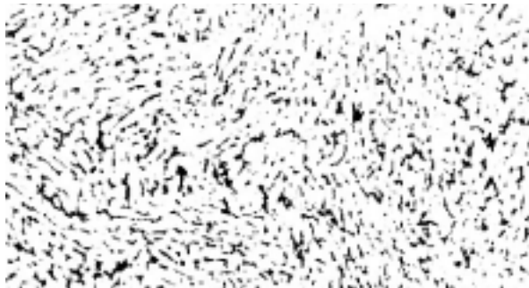
4.2. irudia. Titaniozko barra baten zehar-ebakiaren mikroegitura (X100).
