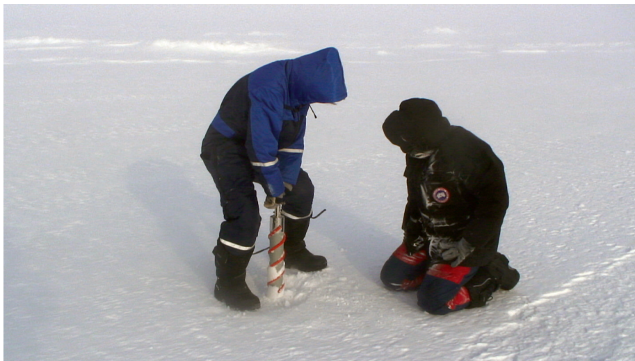
9. irudia. Zientzialariak zunda baten bidez itsasoko izotzaren lodiera neurtzen (Iturria: P. Elosguiren argazkien bilduma).
