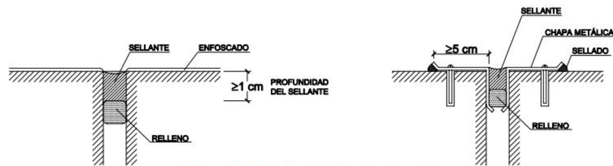
Figura 2.6 Ejemplos de juntas de dilatación
