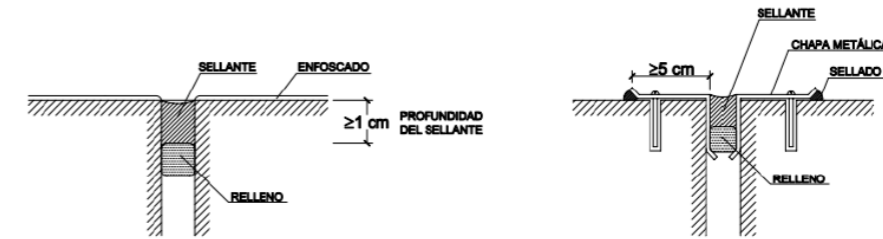
Figura 2.6 Ejemplos de juntas de dilatación
