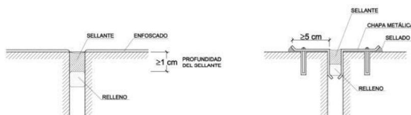
Figura 2.6 Ejemplos de juntas de dilatación
