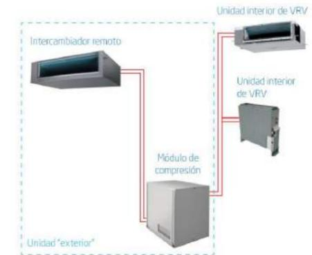
En las imágenes se puede observar cómo funciona el sistema. Un compresor en el interior, el cual se colocara en planta P-1 de la casona, un intercambiador de calor en el falso techo cerca de la fachada, cogerá aire del exterior.
