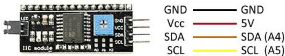
Figura 3.36 Esquema de conexiones display LCD. [32]
