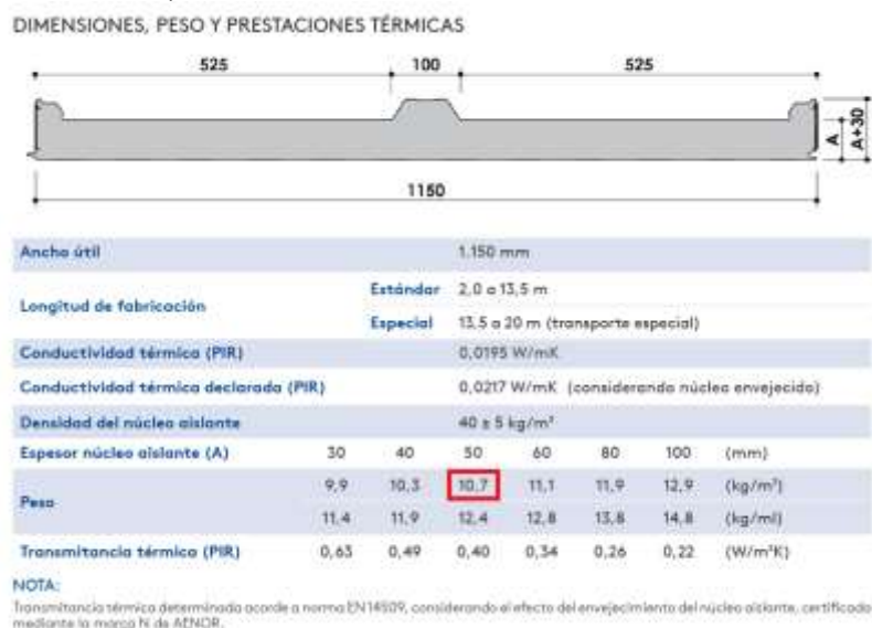
Ilustración 6, Características Panel de Cubierta TZC
