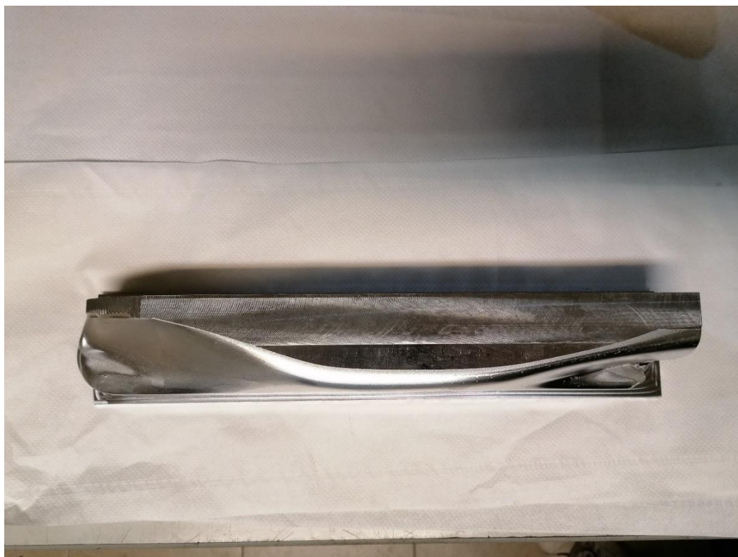
Ilustración 34: Fase 1 del proceso de mecanizado
