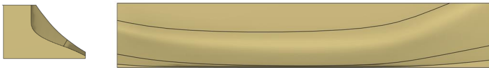
Ilustración 25: Alzado y perfil del útil para la 2ª fase
