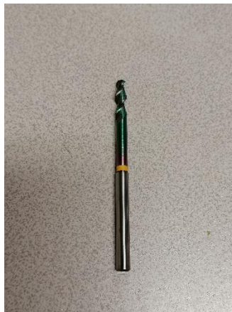
Ilustración 18: Fresa esférica específica para aluminio Ø5mm
