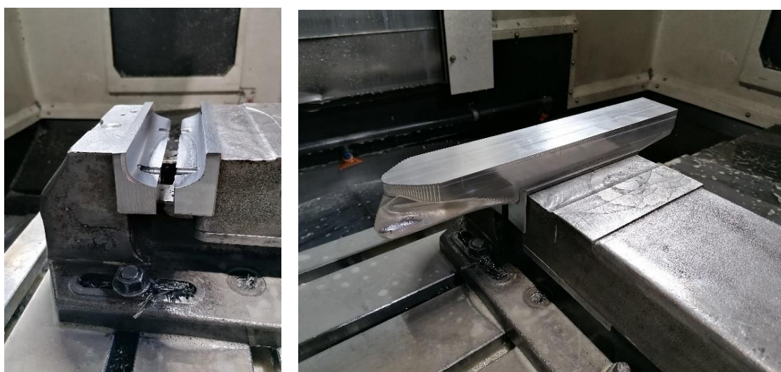
Ilustración 38: Fase útil 2 del proceso de mecanizado y como quedaría la pieza sujeta
