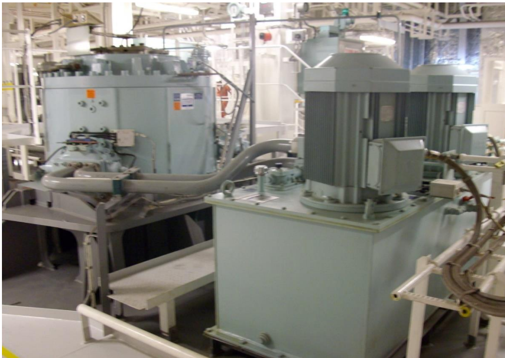
Ilustración 17. Bombas de accionamiento del servo-motor. Fuente: Propia.
