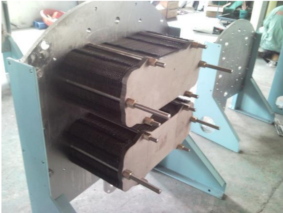
Ilustración 33: Disposición del evaporador y condensador en el FWG. Fuente: Propia.
