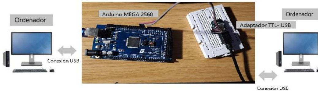
Figura 2: Estructura de comunicación del hardware del entorno de desarrollo
