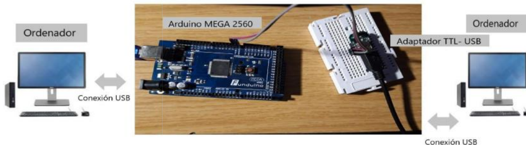
Figura 8: Estructura de comunicación del hardware del entorno de desarrollo
